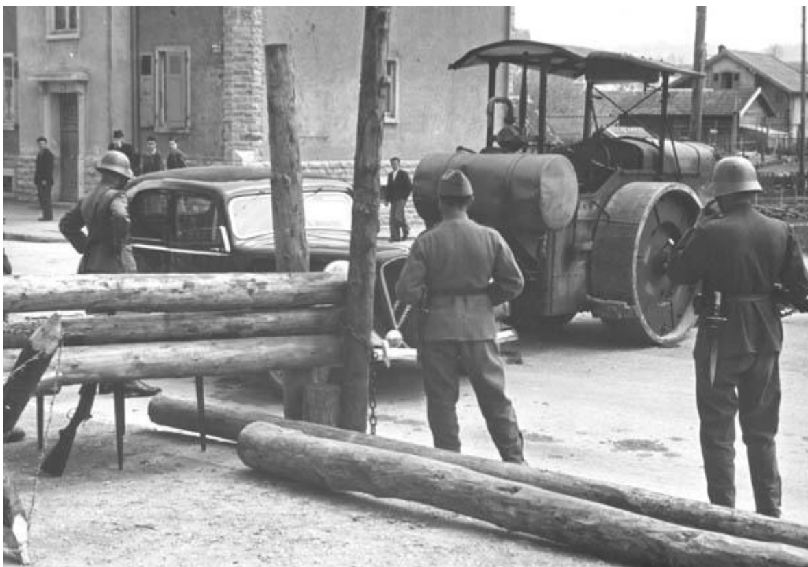
Barrage routier vers 1940-1941. Le rouleau compresseur a été transformé pour fonctionner à l'essence de bois (réservoir supplémentaire installé à l'arrière). Photo Hermann Kohli.
