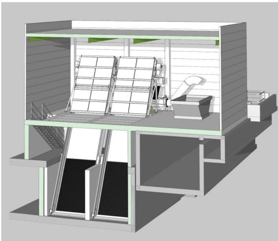
Figure 9 : Vue 3D des dégrilleurs
