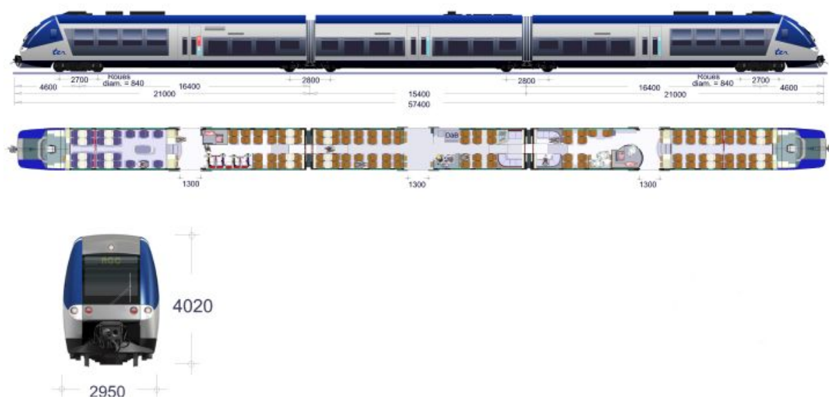
Fig. 55: Dessin d'ensemble du X 76 500 (AGC). 148
